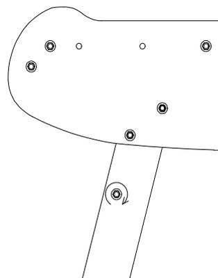
Positionner les traverses en les glissant par le bas entre les pieds, insérer et visser les tiges filetées puis finaliser le vissage des pieds. Ne pas serrer trop fort pour ne pas endommager le placage !
