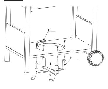
Befestigen Sie die Gasflaschenträger (20 + 21) mit Schrauben (B) und Muttern (H) an der Bodenplatte.
