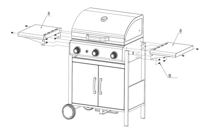
Befestigen Sie die linke Seitenablage (6) mit Schrauben (B), oben an den kurzen Standbeinen und dem Brennergehäuse.
