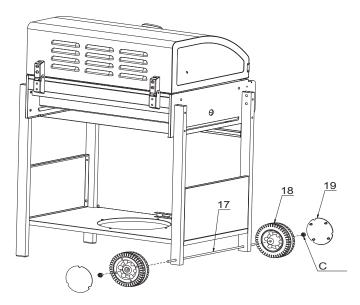
Stecken Sie die Radachse (17) unten durch die Löcher in den kurzen Standbeinen.
