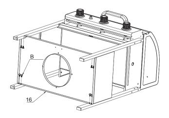
Befestigen Sie die Seitenabdeckungen (15) mit Schrauben (B) zwischen den vorderen und hinteren Standbeinen.
