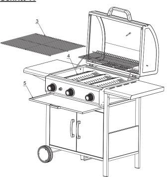
Platzieren Sie die Flammverteiler (4) über den Brennern. Legen Sie die Grillroste (3) in das Brennergehäuse. Schieben Sie die Fettauffangschale (5) unter das Brennergehäuse.
