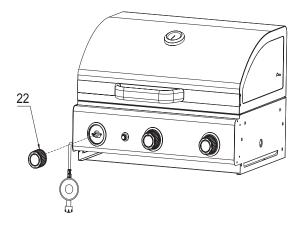
Stecken Sie die Temperaturregler (22) auf die Bedienleiste des Brennergehäuses (1).
