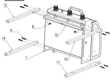
Befestigen Sie das lange Standbein (RB) (11) mit Schrauben (A) an der rechten hinteren Seite des Brennergehäuses (1).
