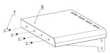
Schrauben Sie die Haken (7) an die linke Seitenablage (6).
