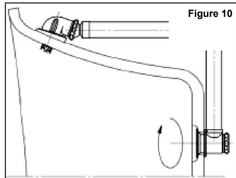
9 - Connect the Overflow Tube and Drain Pipe together with the Water Inlet piece. Choose to connect the Water Inlet piece to water source in the wall or on the floor. (see Figure 11) / *Reliez ensemble le tube de débordement et le tuyau de drain avec le morceau de l'alimentation en eau. Choisissez de relier le morceau de l'alimentation en eau à la source d'eau dans le mur ou au plancher. (Voir la Fig. 11)*
