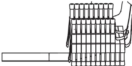
5. Coloque los peldaños atados con la envoltura de plástico dentro de la caja. Coloque los enganches del alféizar doblados encima de los separadores de los peldaños, como se muestra en el gráfico.
